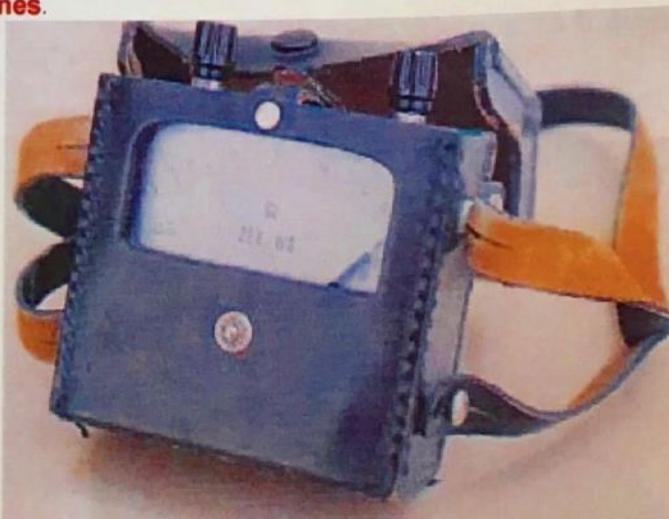
A l'intérieur du boîtier se trouvent l'appareillage électrique et une pile fournissant le courant nécessaire aux mesures. De ce fait, c'est donc un appareil qui, branché sur le circuit, débite du courant dans celui-ci.
