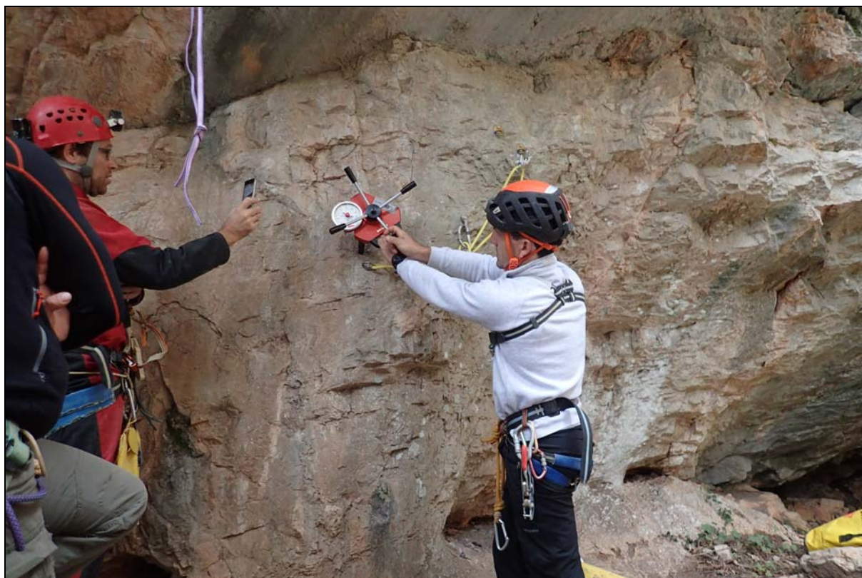
Arrachage d'un spit avec un extracteur par Bernard T..
