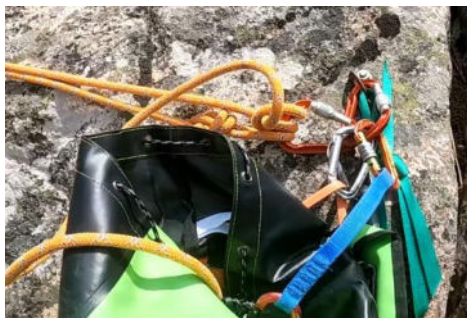
Mise en place finale de la main courante
